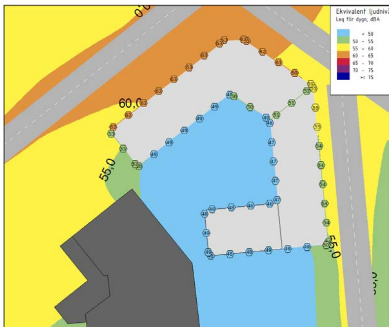
Figur 6. Bullerkarta med ljudutbredning och fasadberäkning. Färger på marken i kartan motsvarar ljudutbredning och markörer på fasad avser fasadberäkningen som jämförs mot riktvärde.
