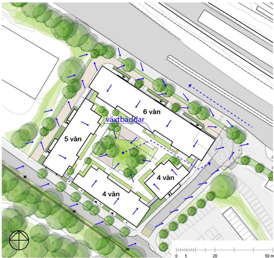
Figur 09. Princip för dagvatten och LOD. Pilar uttridade för att visa den ungefärliga flödesriktningen vid normal nederbörd. Bild: Tyréns
