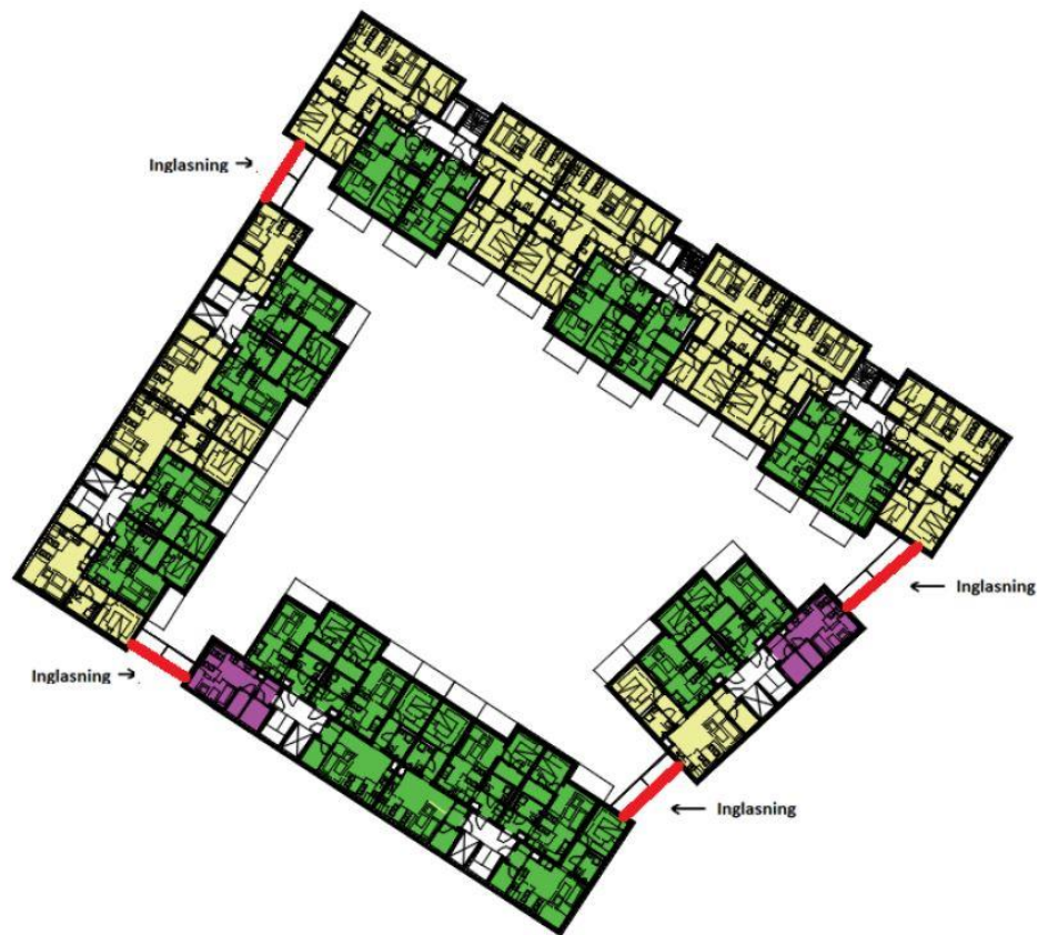
Figur 25. Förslag på planlösningar som innebär att riktvärden för ljudnivåer klaras. Grönt och lila markerade lägenheter uppfyller ljudkraven helt. Gult markerade lägenheter måste ha hälften av bostadsrummen mot en ekvivalent ljudnivå under 55 dBA.
