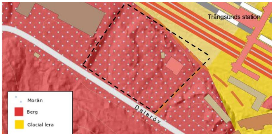
Figur 08. Jordartskarta för planområdet enligt Sveriges geologiska undersökning (SGU). Området består av lera (gult) och berg (rött) med tunt osammanhängande moränlager (ljusblå prickar). Bild: Tyréns/SGU
