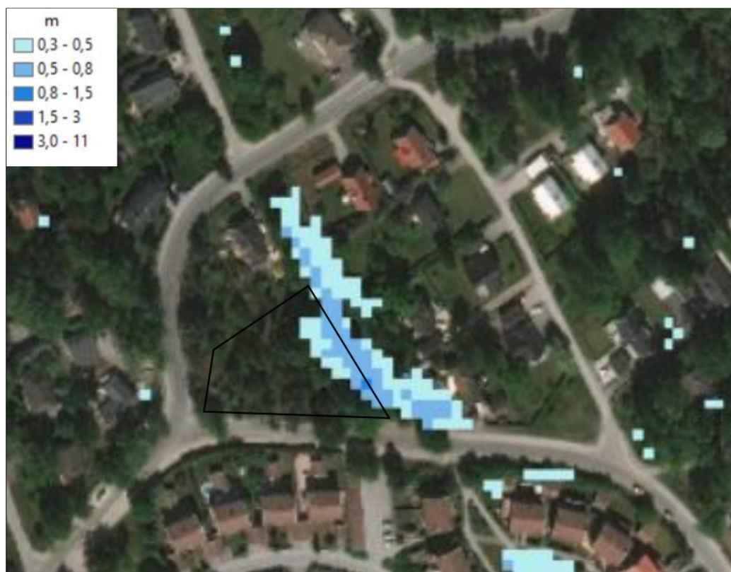
Figur 3.12. Kommunens skyfallskartering över vattendjup (djup >30) vid ett 100-årsregn efter 6 timmar. Planområdet markerat med svart polygon (Källa: GIS-underlag tillhandahålls från Huddinge kommun)
