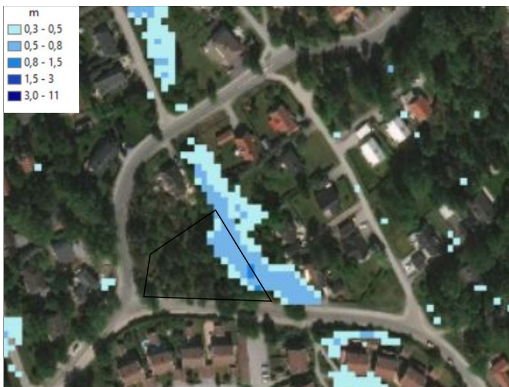
Figur 3.11. Kommunens skyfallskartering över max vattendjup (djup >30) vid ett 100-årsregn. Planområdet markerat med svart polygon. (Källa: GIS-underlag tillhandahålls från Huddinge kommun)
