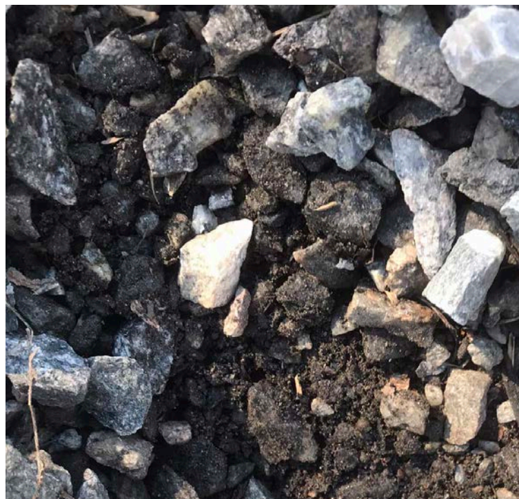
Kolmakadam med bergskross och biokol hjälper till att rena och leda bort dagvatten.
