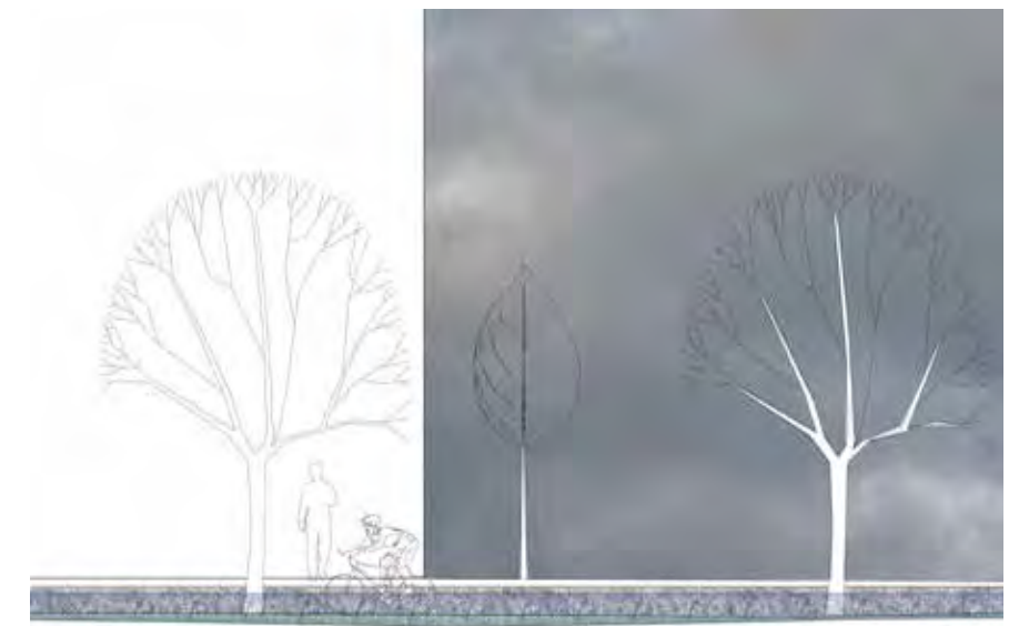
Cykelbanan är smal. För att undvika obehaglig trängsel kan cykelbanan följa vägbansans nivåer. Detta medför att cykelbanan vid ett eventuellt skyfall blir vattenfylld längs en del av sträckan tills dess att vattnet har runnit undan
