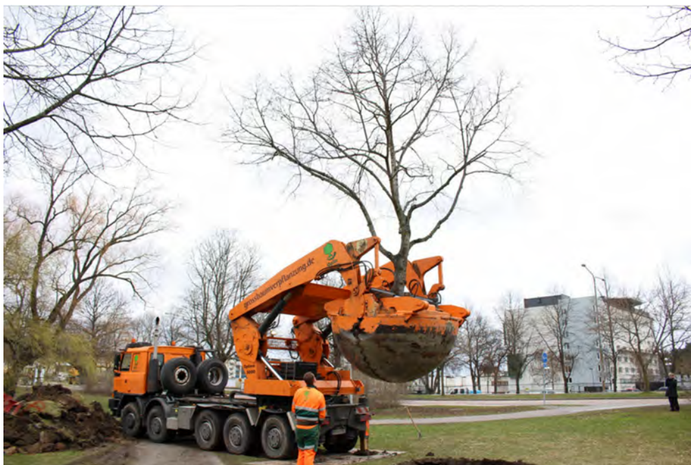
Foto 4: Flytt av träd med specialmaskin Optimal 3000 vilket är den maskinen som skulle kunna vara aktuell vid flytt av skogslönnarna vid Vårby allé. Foto: Johan Östberg och Örjan Stål (Standard för skyddande av träd vid byggnation 2.0 Rapport 2018:02, Alnarp 2018, SLU)
