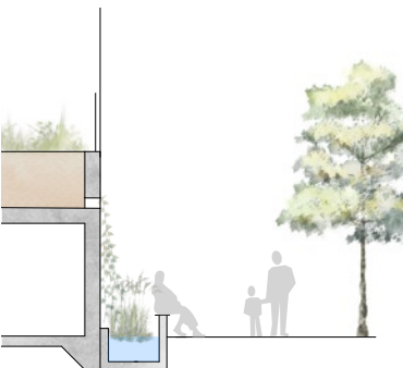
Sektion Öppen dagvattenhantering mot grönstråket
