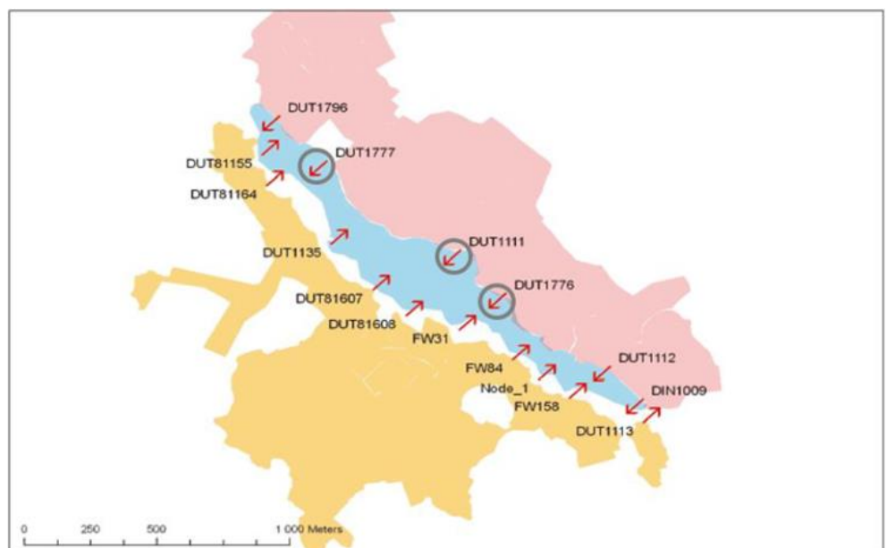
Figur 9. Avrinningsområdet med dagvattenutlopp till Långsjön. Inringade utlopp visar var bräddningar kan ske.
