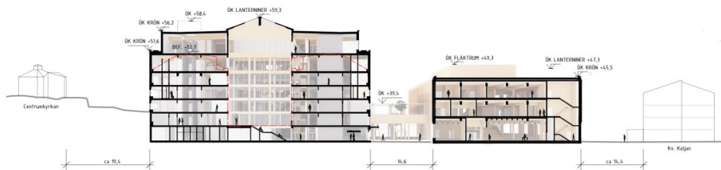
Sektion genom kommunhus och bibliotek. Centrumkyrkan till vänster och kvarteret Koljan till höger. Röd markering visar befintligt kontorshus tak. Cirka 14,4 meter mellan fasad på biblioteket och fasad på kvarteret Koljan och cirka 19,4 meter till centrumkyrkan. Bild: White arkitekter AB
