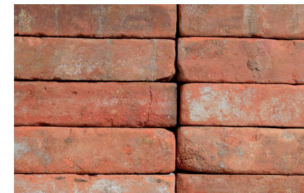
De två översta påbyggda kontorsvåningarna får nya murade fasader av det demonterade teglet från de två utvändiga atrierna och från bröstningarsa som rivs. Nya fasader muras med kalkbruk för framtida demonterbarhet.
