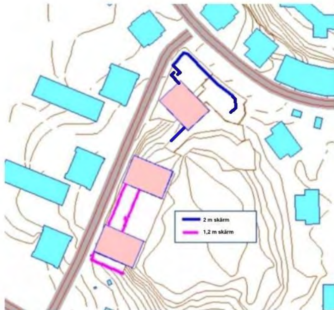
Figur 3 Skärmar kring uteplats för LSS och mellan hus B och C är 1,2 m höga och vid förskola 2 m
