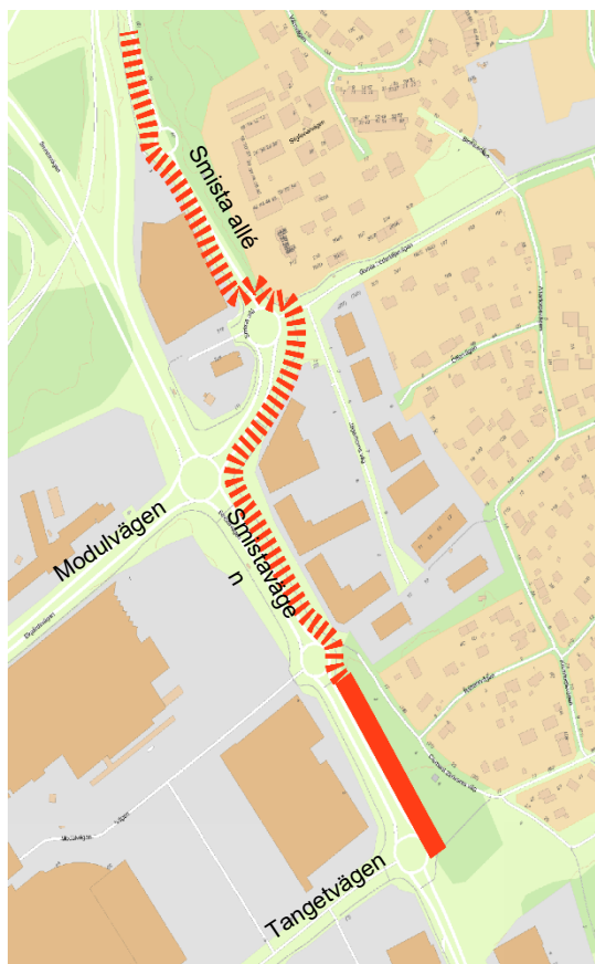
Figur 5. Föreslagen sträckning är markerad i rött för ny gång- och cykelbana längs Smistavägen. Den streckade linjen visar var breddning sker och i fylld linje visar var ny gång- och cykelbanan anläggs.
