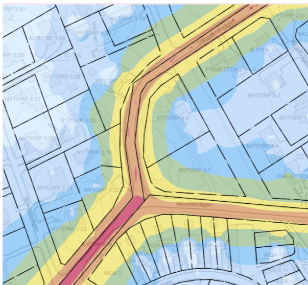
Utdrag från kommunens övergripande bullerkartläggning. Rött fält = 65–70 dBA, orange fält = 60–65 dBA, gult fält = 55–60 dBA, grönt fält = 50–55 dBA, blått fält <50 dBA.
