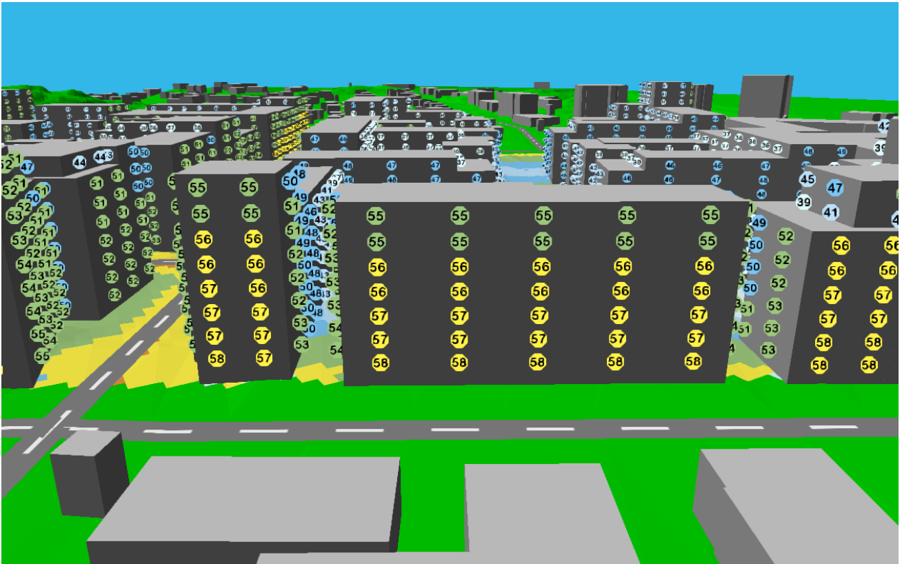
Figur 11 Kv 6 Ekvivalent ljudnivå mot Centralvägen 2040 med tvärförbindelsen
