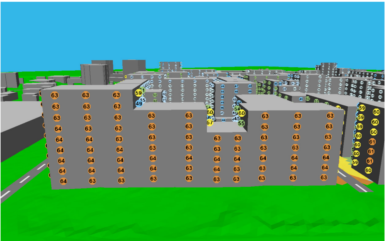
Figur 22 Kv 10 Ekvivalent ljudnivå mot Storängsleden 2040 utan tvärförbindelsen
