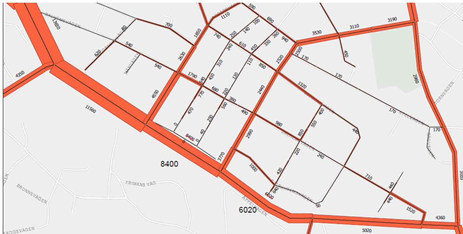
Figur 1 Trafikmängd för prognosår 2040 med Tvärförbindelse. Bild erhållen från Huddinge kommun och gäller vardagsmedeldygnstrafik.
