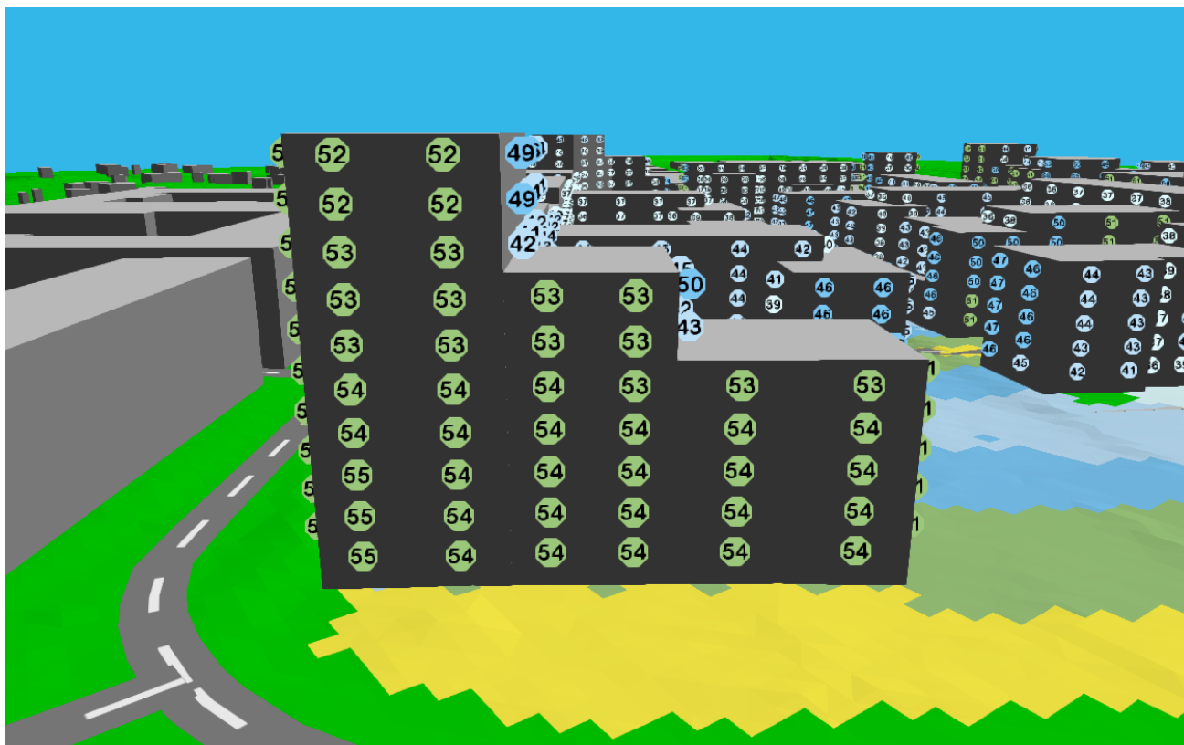
Figur 3 Kv 1 Ekvivalent ljudnivå mot Förrådsvägen 2040 med tvärförbindelsen.
