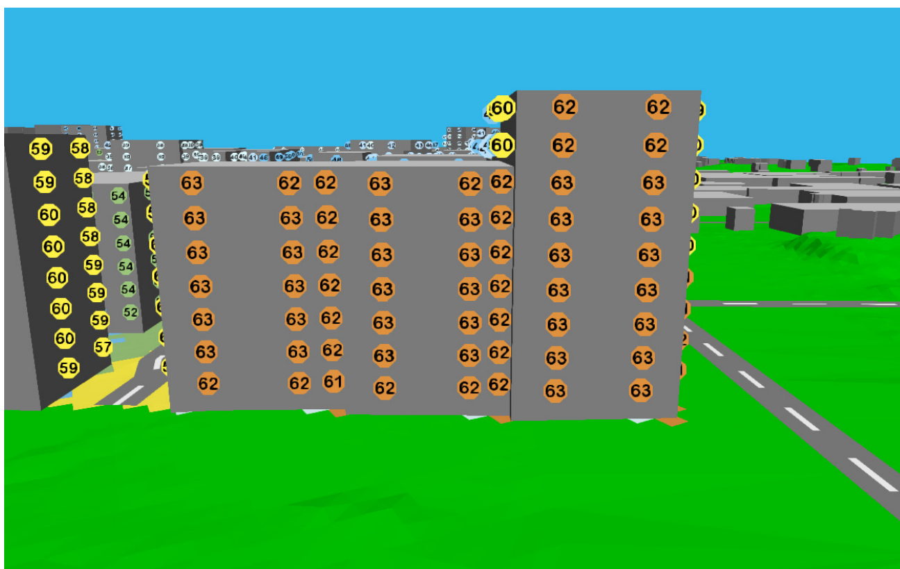
Figur 18 Kv 12 Ekvivalent ljudnivå mot Storängsleden 2040 utan tvärförbindelsen
