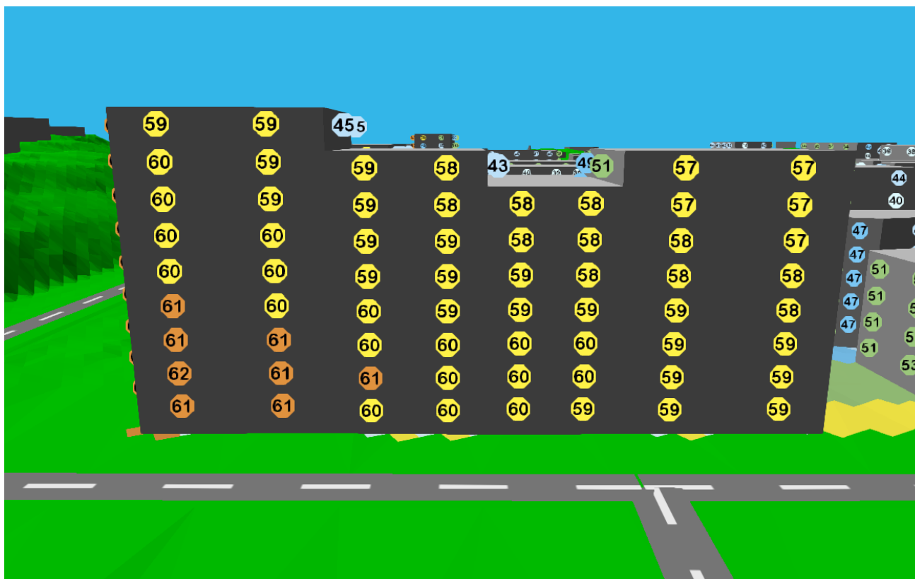
Figur 16 Kv 12 Ekvivalent ljudnivå mot Centralvägen 2040 utan tvärförbindelsen
