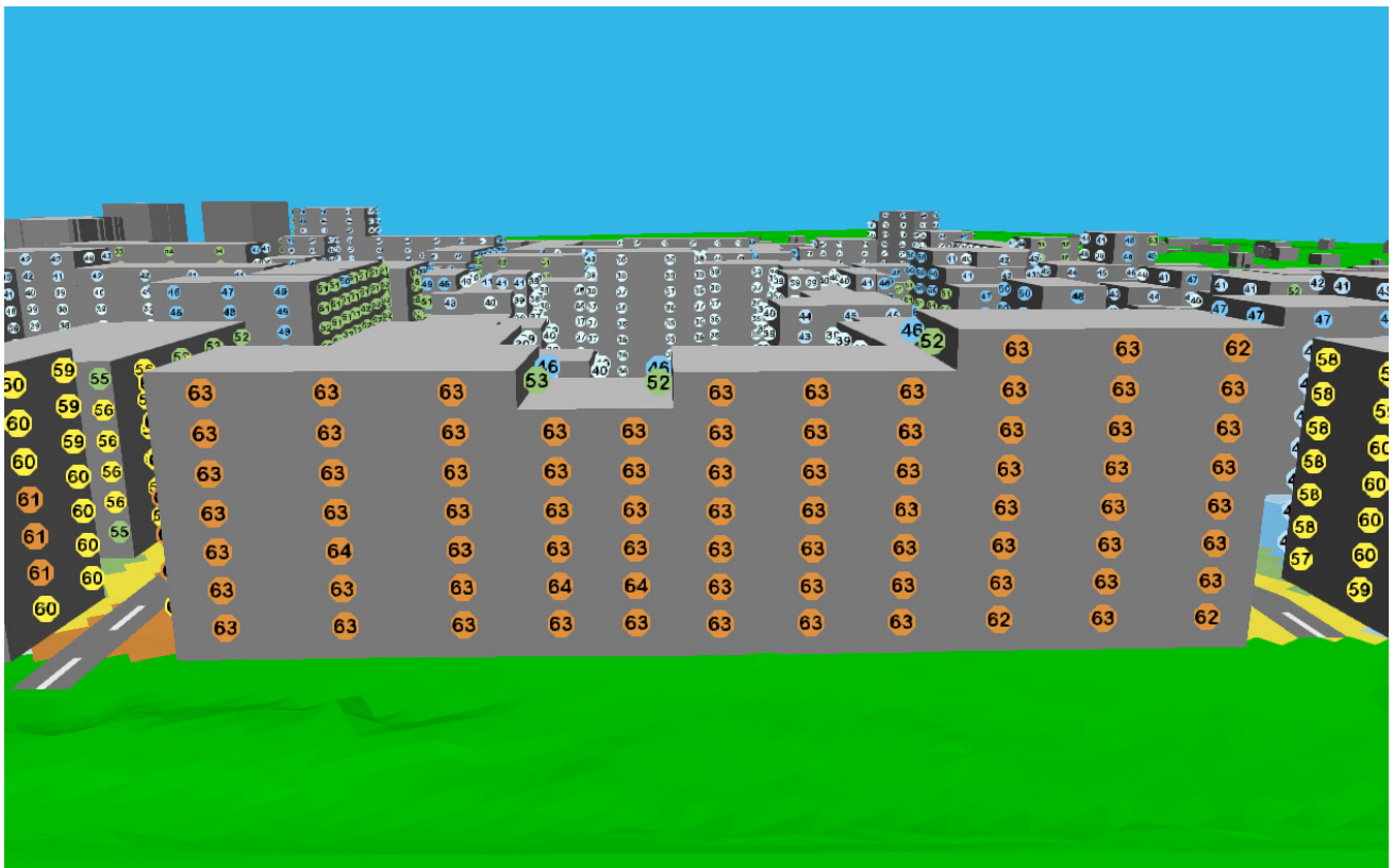
Figur 20 Kv 11 Ekvivalent ljudnivå mot Storängsleden 2040 utan tvärförbindelsen
