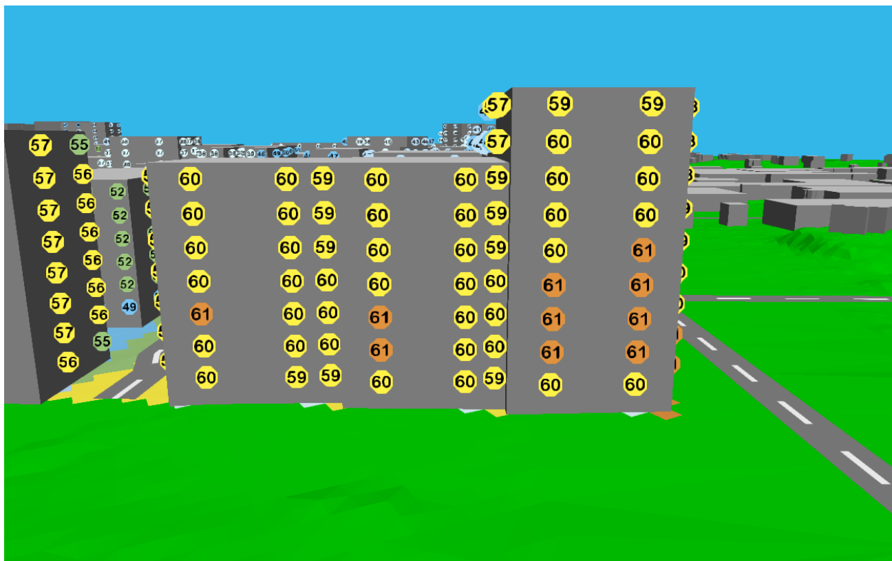
Figur 17 Kv 12 Ekvivalent ljudnivå mot Storängsleden 2040 med tvärförbindelsen
