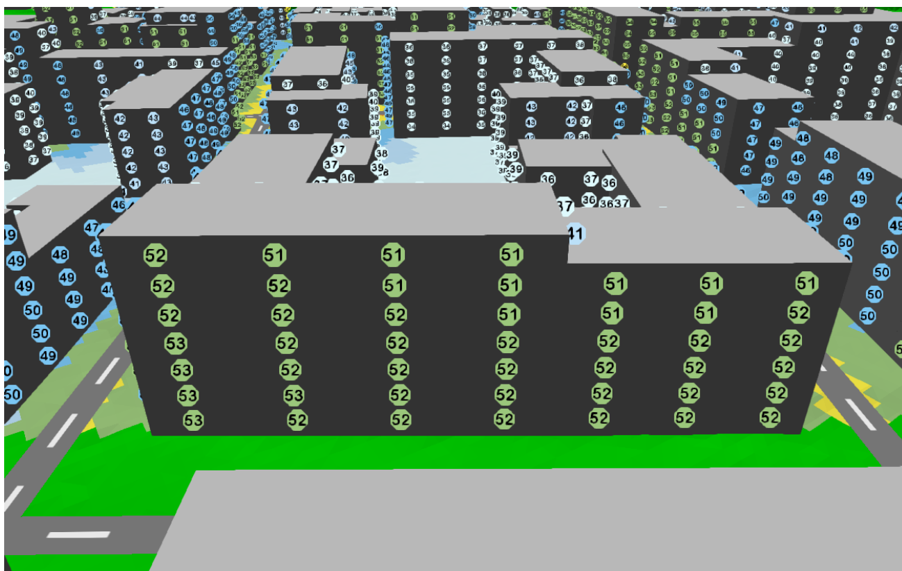
Figur 5 Kv 2 Ekvivalent ljudnivå mot Sjödalsvägen 2040 med tvärförbindelsen.
