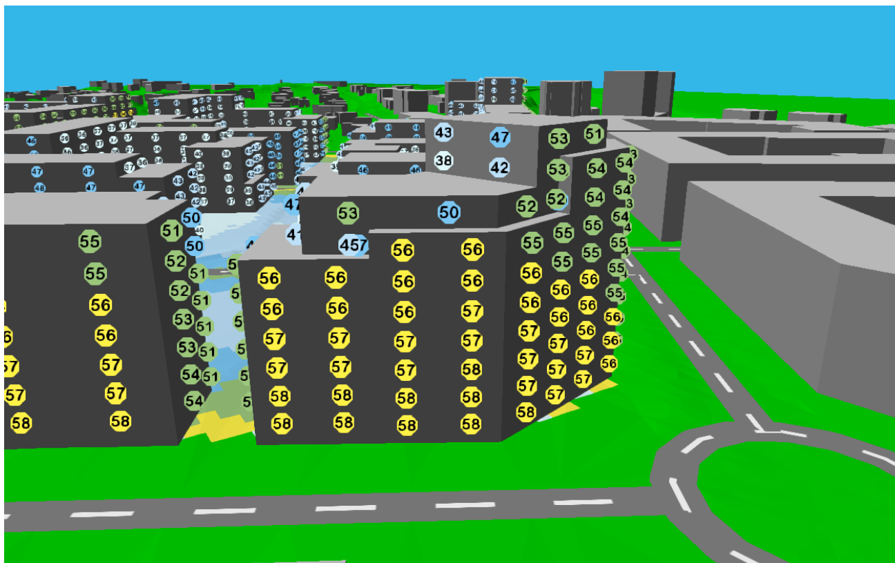
Figur 9 Kv 3 Ekvivalent ljudnivå mot Centralvägen 2040 med tvärförbindelsen
