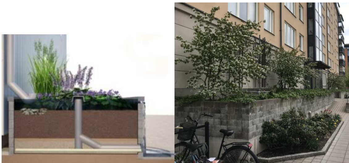
Figur 17. Tvärsnitt av ett exempel på en upphöjd växtbädd till vänster och foto av upphöjd samt nedsänkt växtbädd till höger.
