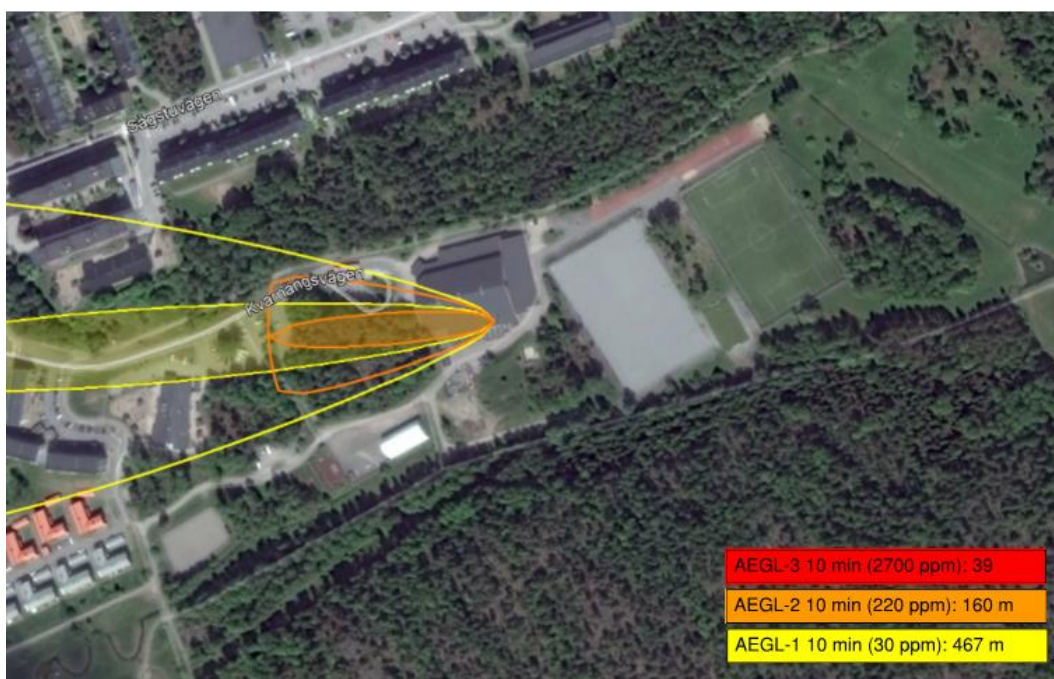
Figur 10. Visar gasmolnets spridning vid neutral skiktning (Stabilitetsklass D) med tunggasmodell. AEGL-2 10 min uppstår inom 160 m avstånd från utsläppspunkten. Värdet för AEGL-3 10 min markeras inte på bilden på grund av osäkerheter vid projektionen av så korta avstånd.
