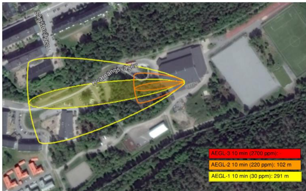
Figur 12. Gasmolnets spridning vid neutral skiktning (Stabilitetsklass D) med gaussisk spridningsmodell. AEGL-2 10 min uppstår på 102 m avstånd från utsläppspunkten.
