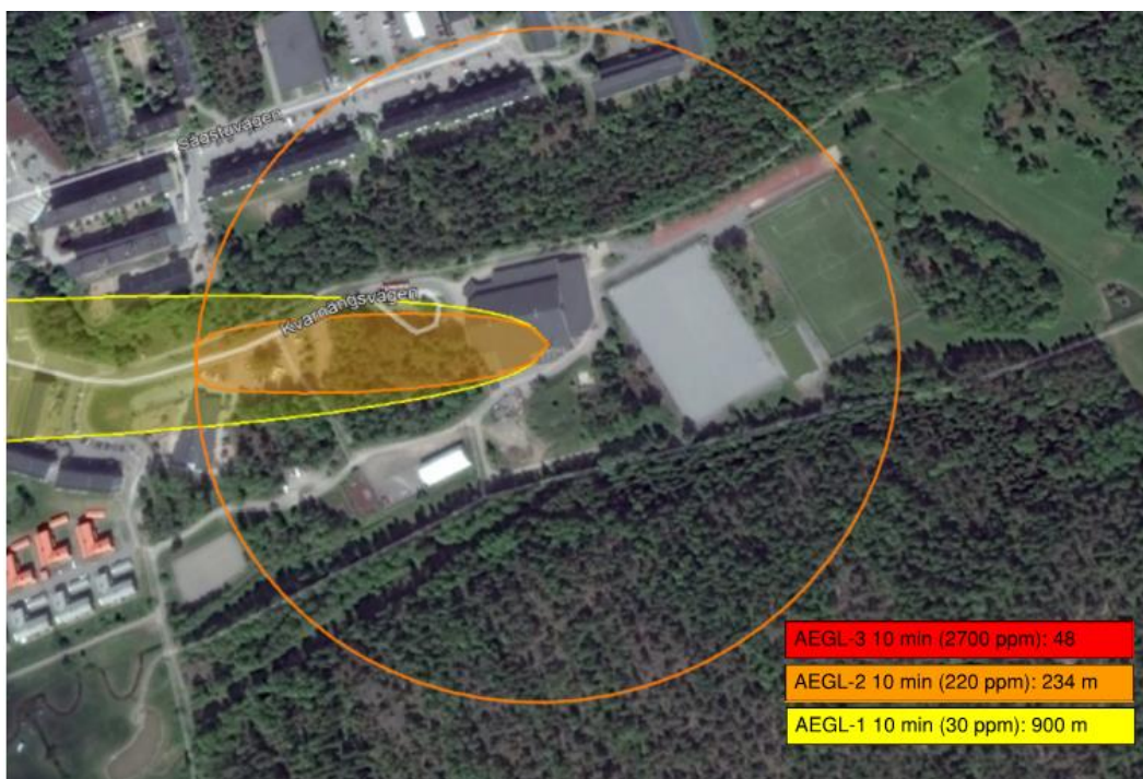
Figur 8. Visar gasmolnets spridning vid svagt stabil skiktning (Stabilitetsklass E) med tunggasmodell. AEGL-2 10 min uppstår inom 234 m avstånd från utsläppspunkten. AEGL-3 10 min markeras inte på bilden på grund av osäkerheter vid projektionen av så korta avstånd.
