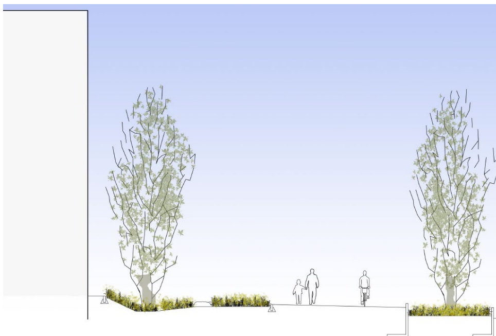
Sektion som visar på utformningen av utvecklad gång- och cykelväg, söder om den nya sim- och idrottshallen. Belysningsarmaturer ska placeras längs stråket. Bild: Wi Landskap.
