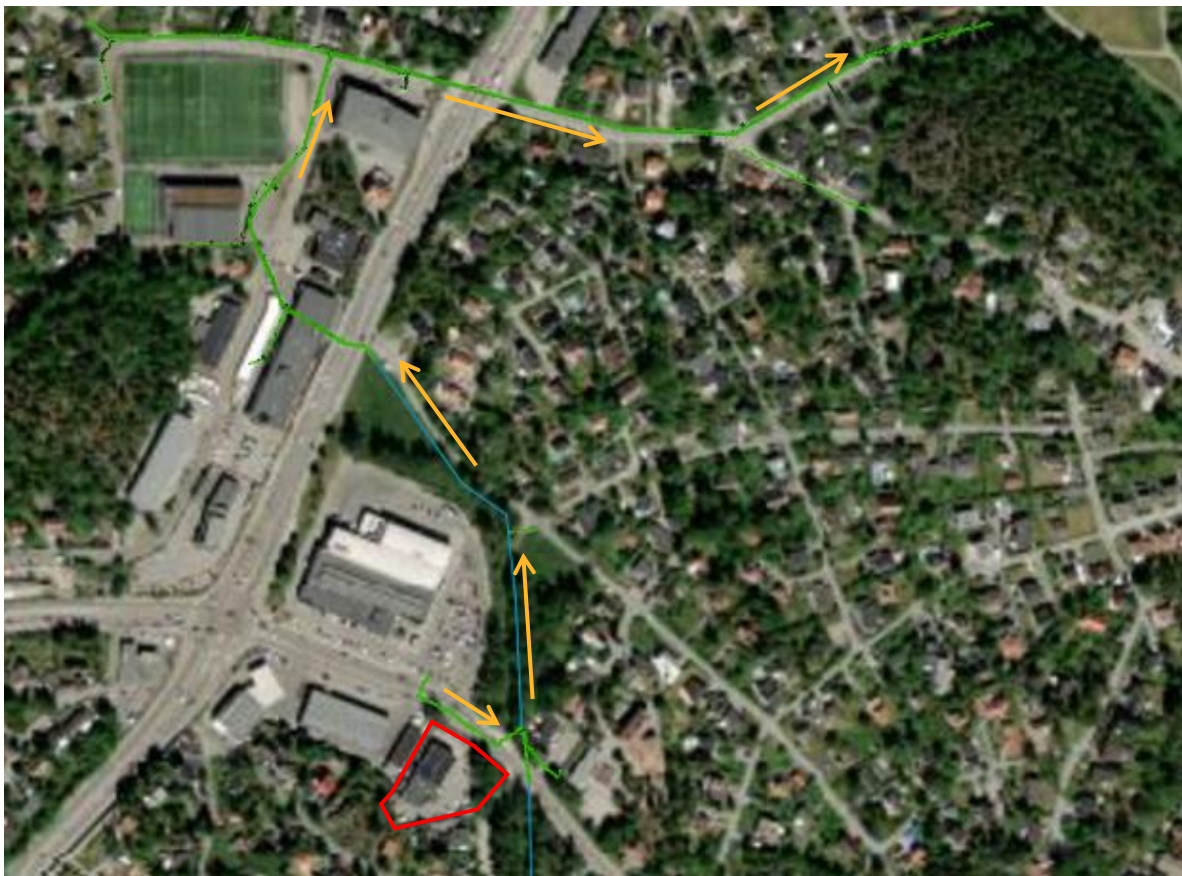
Figur 4-1. Fagerängsdiket och befintliga dagvattenledningar samt kulvert som leder bort dagvatten från planområdet till Kräppladiket. Gröna linjer avser befintliga dagvattenledningar, blå linjer avser Fagerängsdiket. Planområdet markerat med röd polygon.
