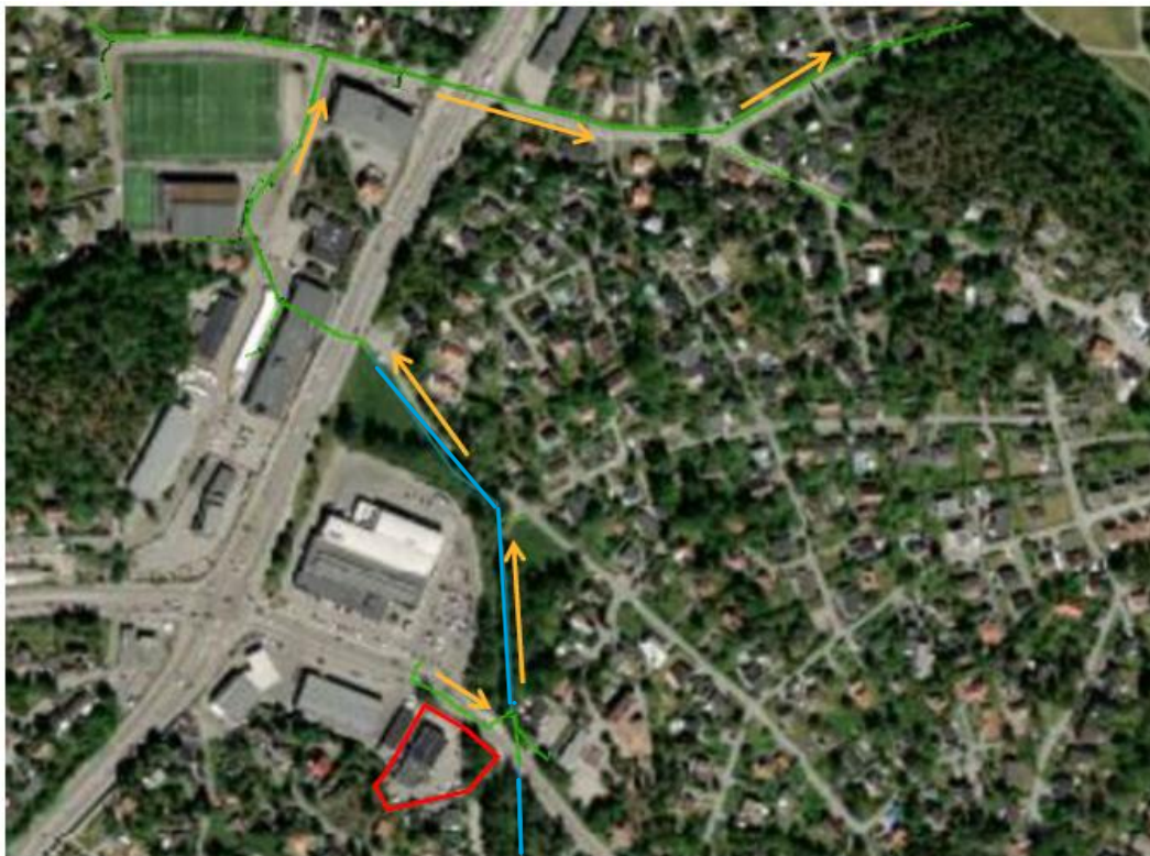
Figur 9. Fagerängsdiket och befintliga dagvattenledningar samt kulvert som leder bort dagvatten från planområdet till Kräppladiket. Gröna linjer avser befintliga dagvattenledningar, blå linjer avser Fagerängsdiket. Planområdet markerat med röd polygon. Källa: Dagvattenutredning, Structor.
