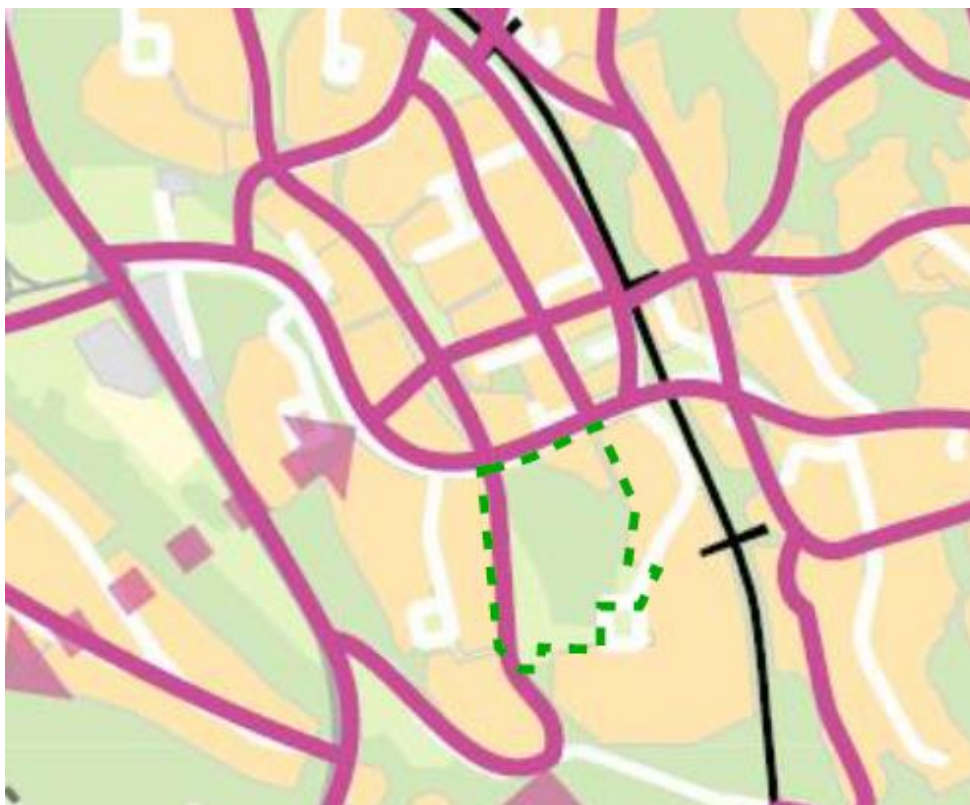
Bild 34: Huddinge kommuns planerade övergripande gångvägnät för Skogås enligt Gångplan för Huddinge kommun (2018). Rosa indikerar det övergripande gångvägnätet. Planområdet är streckat i bilden.
